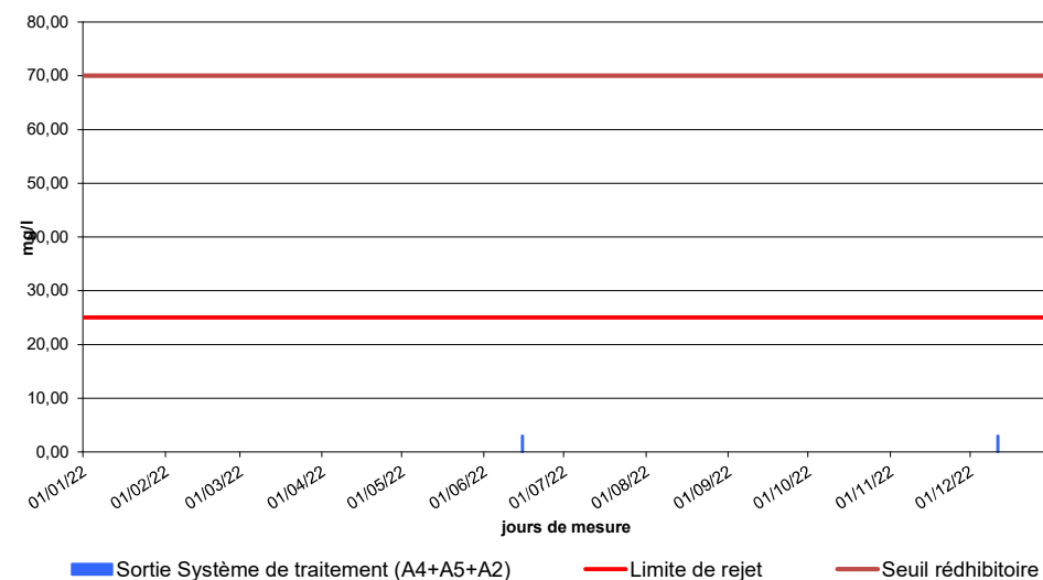
NGL : concentration en sortie du système de traitement les jours de mesures
