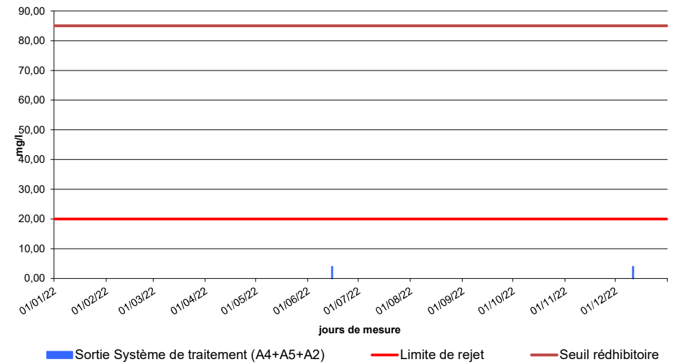
DCO : concentration en sortie du système de traitement les jours de mesures
